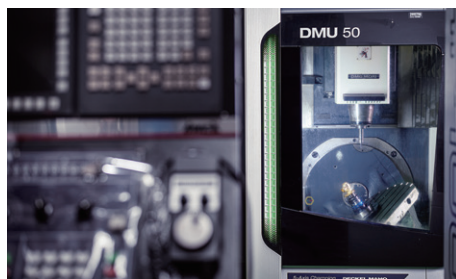
DMG MORI DMU50 5軸マシニングセンター DMG MORI DMU50 5-axis milling machine
