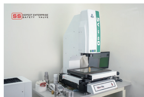
2.5D 画像測定器 MimnTaiy SV-2.5D 2.5D Optical Measuring Instrument
