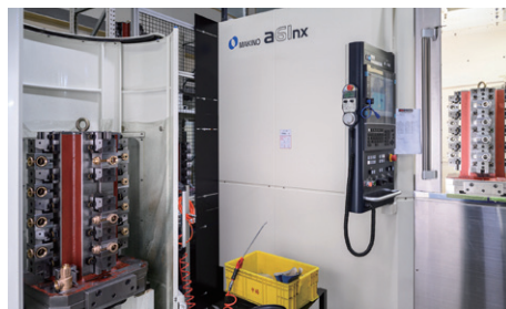
Makino a61nx 横型マシニングセンター *2 Makino a61nx Horizontal milling machine
