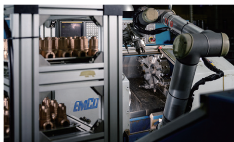
FEMCO 旋盤、 URロボットアームによる自動上下料対応 FEMCO turning machine with UR robotic arms HL-25*4 HL-25N *7
