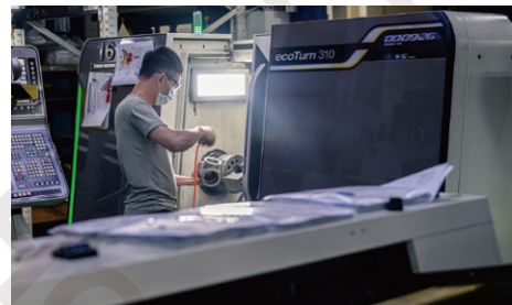
DMG MORI EcoTurn 310*2 車銑複合 DMG MORI EcoTurn 310 mill-turn machine
