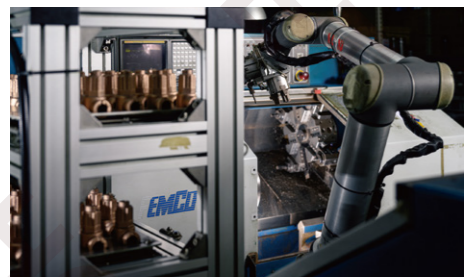
FEMCO 車床配合UR機械手臂自動上下料 FEMCO turning machine with UR robotic arms HL-25*4 HL-25N *7
