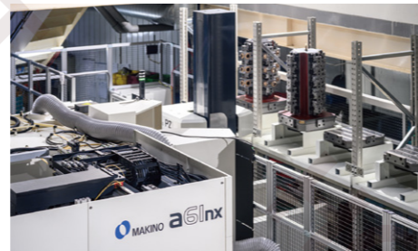
Makino PZ1 *1 自動化工作站 Makino PZ1 pallet handling system
