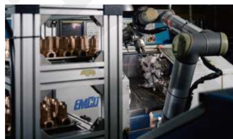
FEMCO 車床配合UR機械手臂自動上下料 FEMCO turning machine with UR robotic arms HL-25 x4 HL-25N x7
