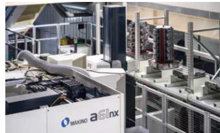
Makino PZ1 自動化パレット搬送システム Makino PZ1 pallet handling system
