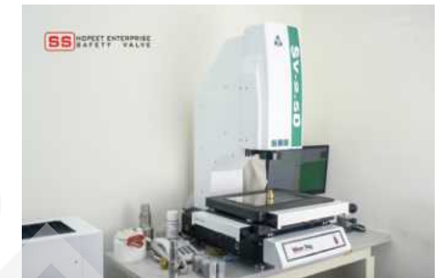
2.5D 画像測定器 MimmTaiy SV-2.5D 2.5D Optical Measuring Instrument
